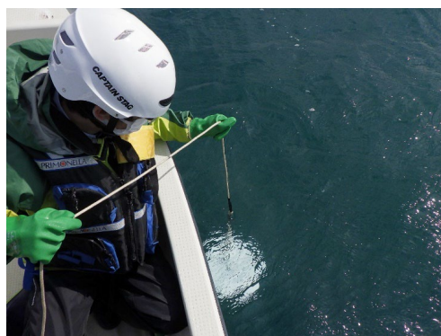
船舶から海水の透明度を調査している様子
